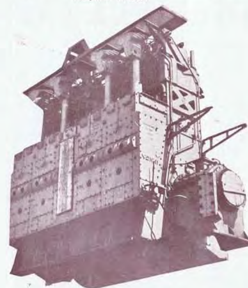
Motor Diesel 604/90 de 1.800 B. H. P. construido para la motonave "Huesca"
