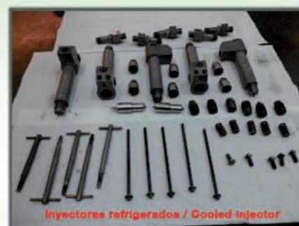
inyectores refrigerados / Cooled injector
