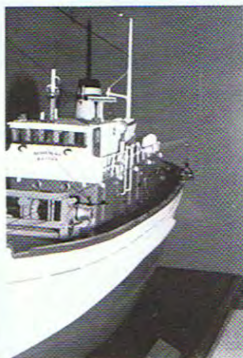
Detalle del puente con la maquinilla en primer plano, al fondo el pescante.
